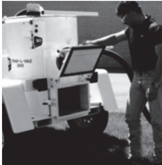
Figura 3-7. Abra la compuerta de descarga para retirar los residuos sólidos del depósito.
