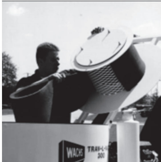
Figura 3-8. Abra la tapa del depósito y limpie el filtro después de cada uso.
