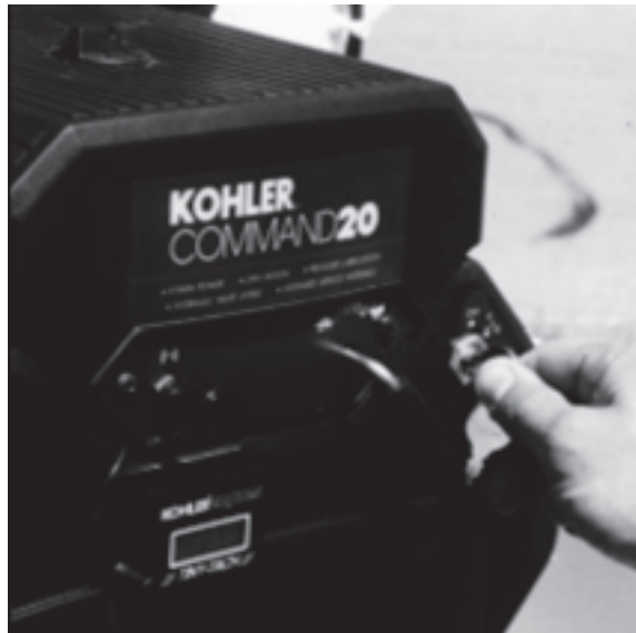
Figura 3-5. Use la llave de ignición para arrancar el motor.
