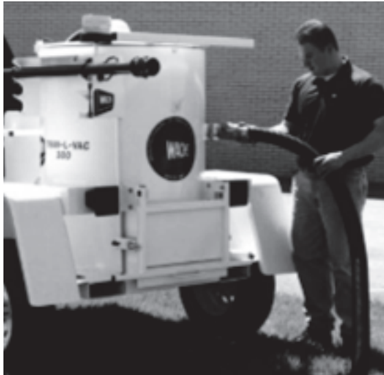
Figura 3-4. Conecte la manguera de aspiración al puerto de entrada de vacío.
