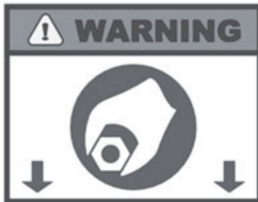
Figure 2-5. Cette étiquette est apposée sur le carter de transmission. Les brides du moteur doivent être fixées pour utiliser la machine en sécurité.
