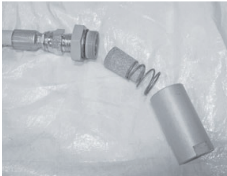
Figure 6-4. Inspectez le filtre à air une fois par semaine. Remplacez-le si nécessaire.
