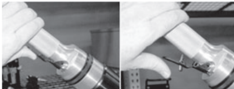
Figure 2-2. Appuyez sur la commande du moteur pneumatique pour mettre en service la machine SDSF (à gauche). Lorsque vous relâchez la commande (à droite), le moteur pneumatique s'arrête.
