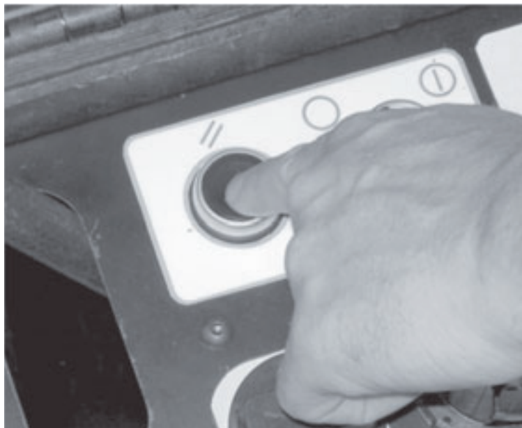
Figure 5-45. Le bouton Reset réinitialise le module ACM après une coupure de la pression ou un arrêt d'urgence.
