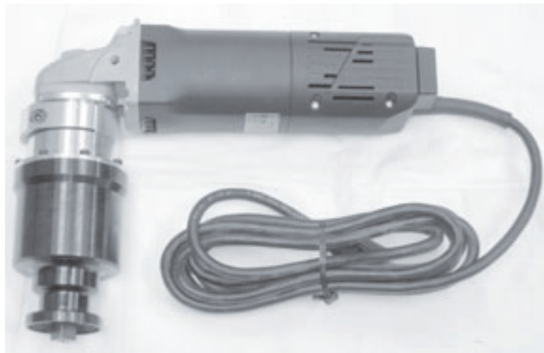
Figure 3-13. Le moteur électrique (110 V : 80-4005-01 ; 220 V : 80-4006-01) entraîne toutes les tailles de machines SDSF.
