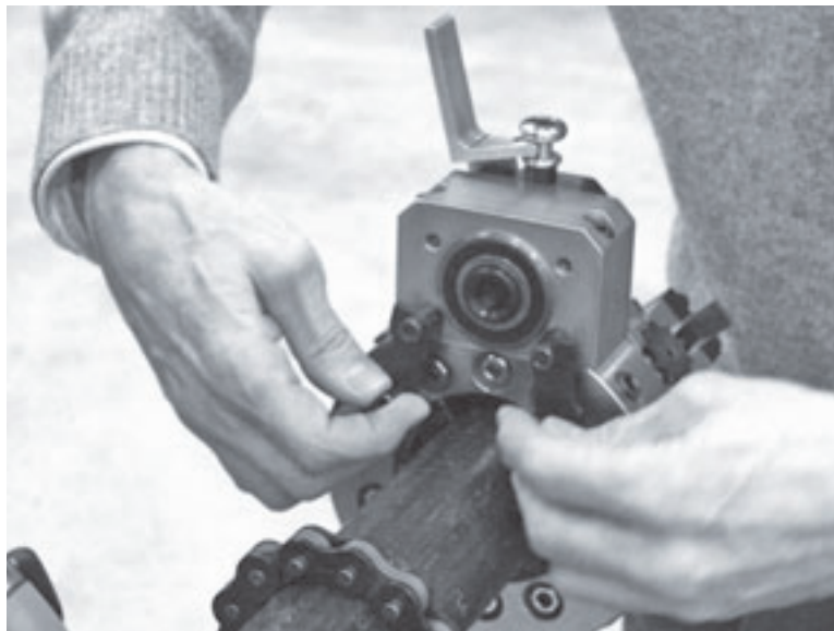
Figure 5-20. Faites tourner les brides vers le bas pour fixer le moteur.
