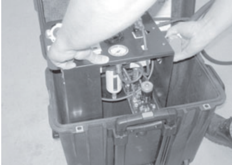
Figure 6-12. Levez le tableau de commande pour le sortir de la caisse pour l'entretien ou vidanger l'eau accumulée.
