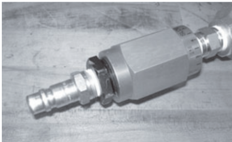
Figure 5-53. Montez l'embout fourni sur le moteur pneumatique pour l'utiliser avec le module ACM.
