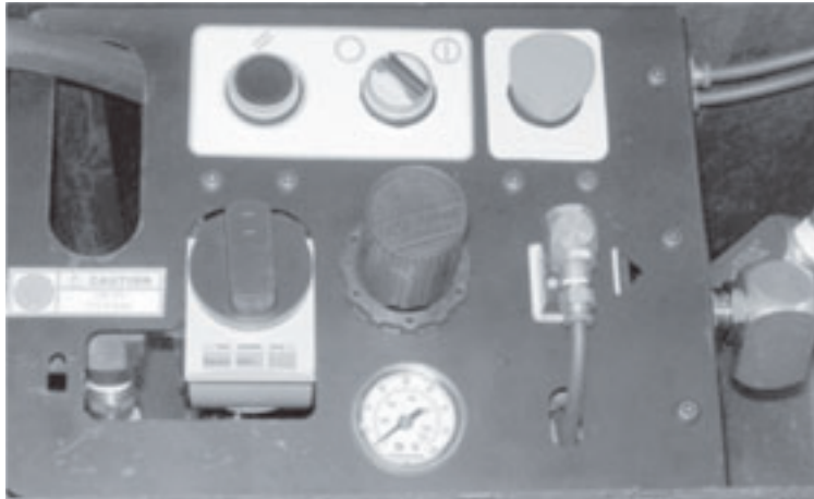
Figure 5-39. Les commandes du module ACM doivent être prêtes à fonctionner (voir la photo) avant de raccorder les canalisations pneumatiques
