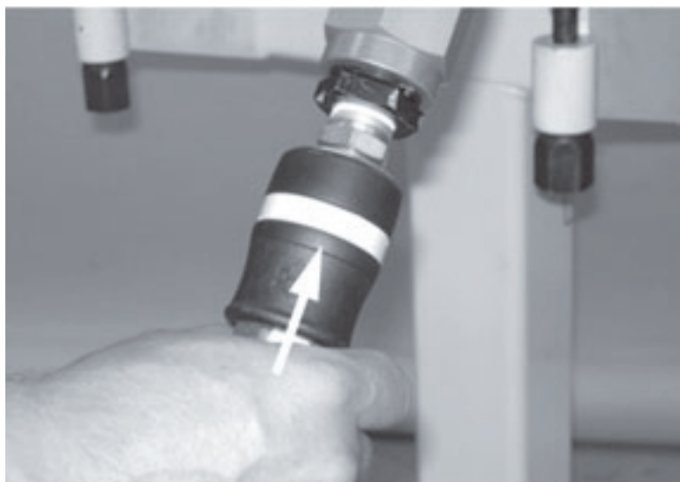
Figure 5-50. Poussez le raccord rapide de la canalisation pneumatique sur le raccord du moteur pneumatique jusqu'à ce qu'il soit bloqué.
