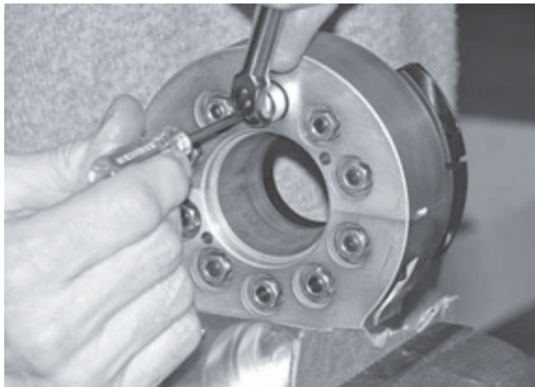
Figure 6-8. Le serrage du roulement supérieur centre tous les roulements.
