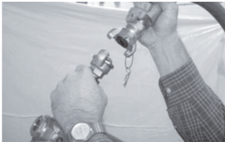
Figure 2-4. Débranchez l'alimentation pneumatique en déposant la canalisation pneumatique de la transmission pneumatique.
