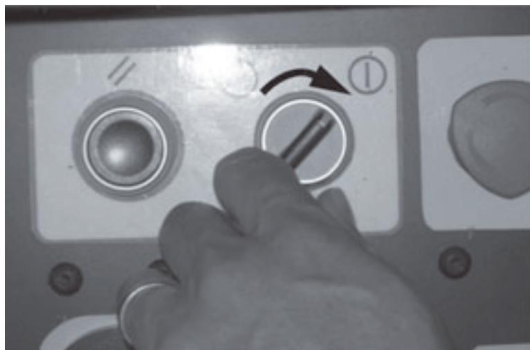
Figure 5-46. Tournez le bouton d'activation de la commande à distance (Remote Enable) pour pouvoir utiliser la machine à distance.
