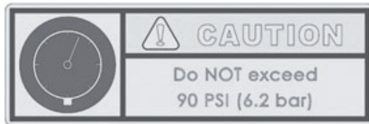
Figure 2-8. Cette étiquette est apposée sur le moteur pneumatique. N'utilisez pas une pression de l'air supérieure à 6,2 bars.
