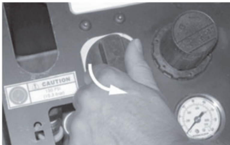
Figure 5-44. Tournez la vanne de coupure (ON/OFF) dans le sens contraire des aiguilles d'une montre en position ON (représentée en position ON).
