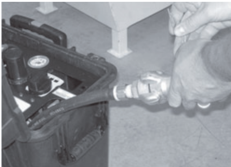
Figure 5-40. Raccordez le tuyau provenant de la source d'air comprimé au raccord d'entrée du module ACM.
