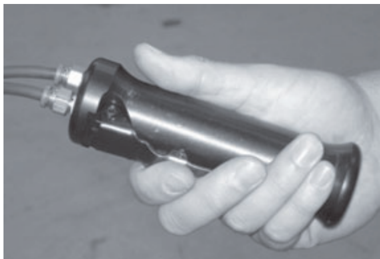
Figure 5-47. Appuyez sur la gâchette du pendulaire pour faire fonctionner la machine.
