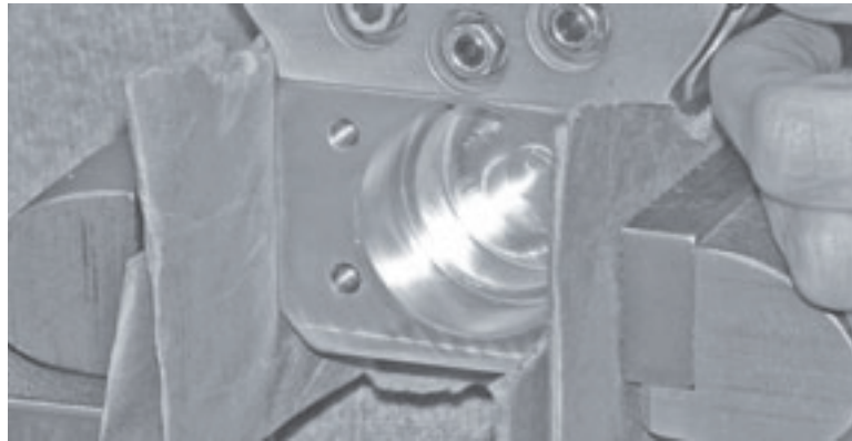
Figure 6-6. Un étau à mâchoires tendres évite d'endommager le carter de transmission.
